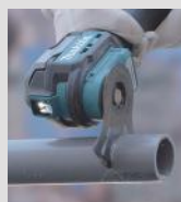
Corte de tubos de PVC
