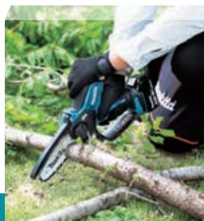
DUC150Z: Corrente 80TXL, barra de guia de 10 cm, recipiente de óleo e lima redonda. Sem baterias, sem carregador e sem mala no equipamento base.
